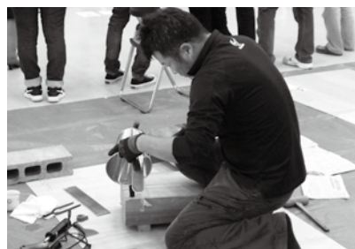
◀▼銅板から手桶を製作(県板金(工))
