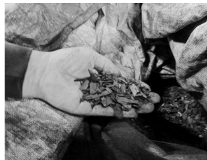
▲土壌改良用や床下調湿用などの新用途炭として製品化するものは、細かく砕く。脱臭効果もあるのが炭の特徴。福井豪雨の際に床下調湿材として使われたときは、脱臭効果が評価されたという。
