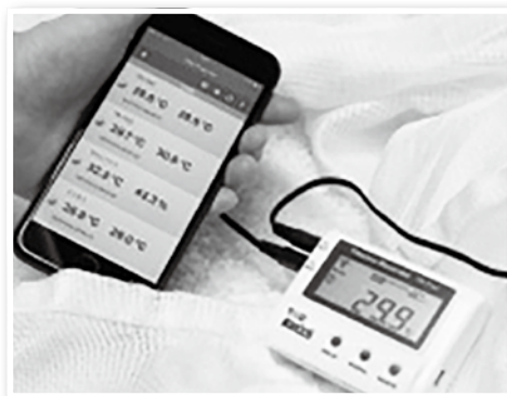
▲製麴温度制御システム
