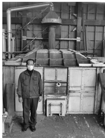
▲木炭を焼成する窯。 1回の稼働で約5m 3 の炭を生産できる。
